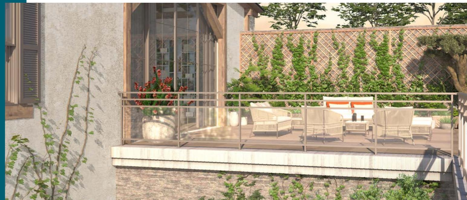
**Remplissage** Vitrage clair norme 44.2 avec 2 vides sous main courante
